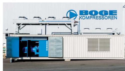
Wenn es um die sichere und wirtschaftliche Produktion absolut ölfreier Druckluft geht, punkten die Schraubenkompressoren der SO-Baureihe mit „Effizienz-Garantie“. Je nach Einsatzbereich erfolgt die Kühlung per Wasser oder Luft, und die große Modellauswahl in allen Leistungsklassen von 45 bis 355 kW ermöglicht – in Kombination mit hochspeziellen Systemkomponenten – eine gezielte Abstimmung des Druckluftsystems auf Ihren Bedarf.
