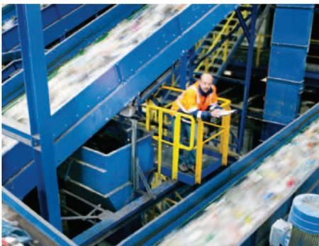
**Die Fördergeschwindigkeit von 3 Metern pro Sekunde ist für das Auge fast nicht zu erfassen.**
